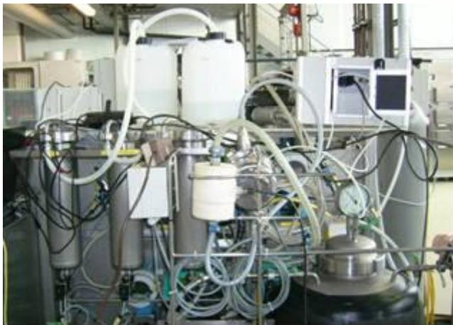
Capteurs spécifiques et unité d'acquisition et de traitement de données pour le contrôle de procédé de la bière
