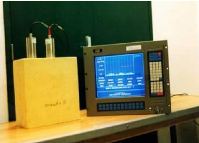
Contrôle d'isolation des matériaux dans les procédés de transports de Gaz Naturel Liquéfié
