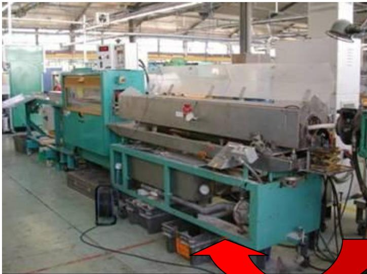
Contrôle automatique d'épaisseur des pièces en caoutchouc en ligne de production
